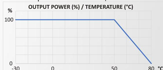
Таким образом, если зарядное устройство вынуждено работать при температуре выше + 50 ° C, оно просто снизит выходную мощность до соответствующего значения в приведенной выше таблице и продолжит нормальную работу.
